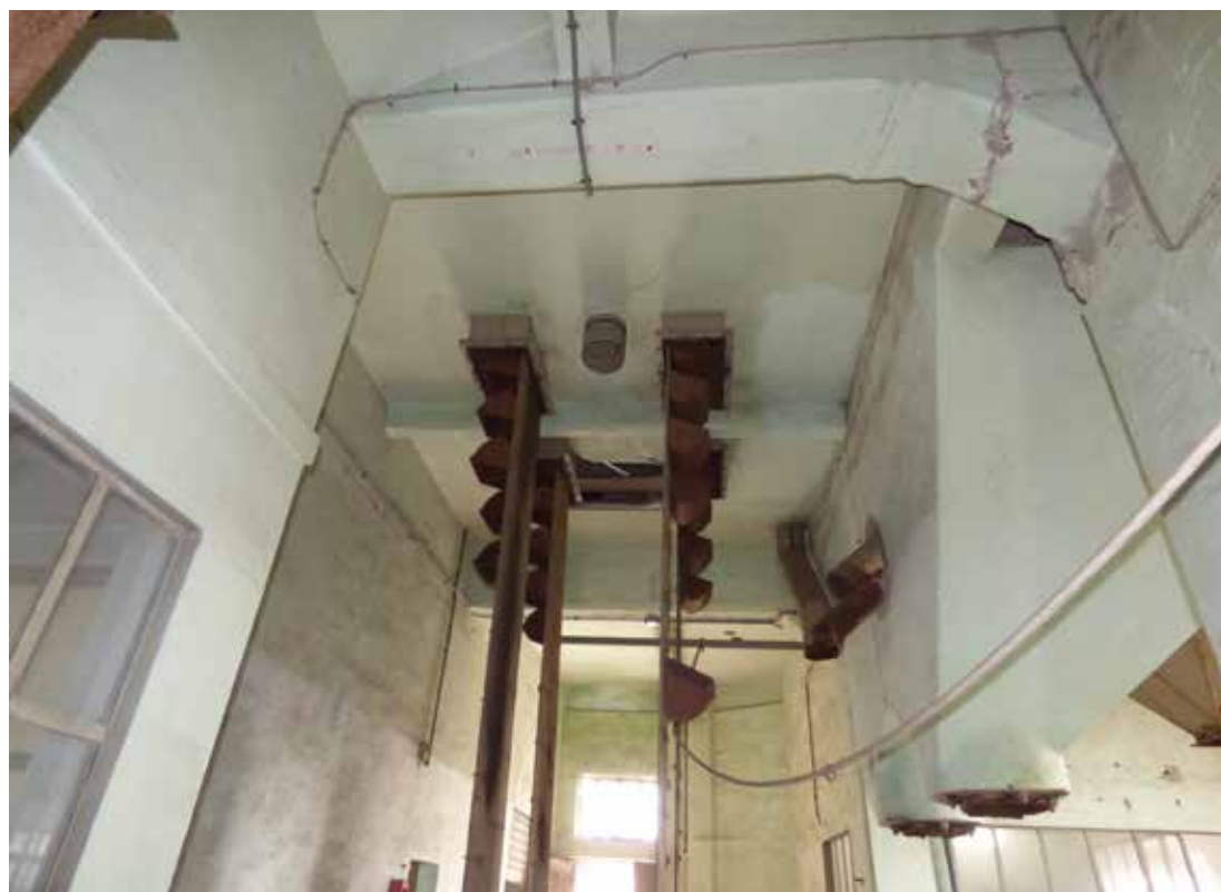
32. Sistema interno di trasferimento verticale con doppi nastri a tazza
