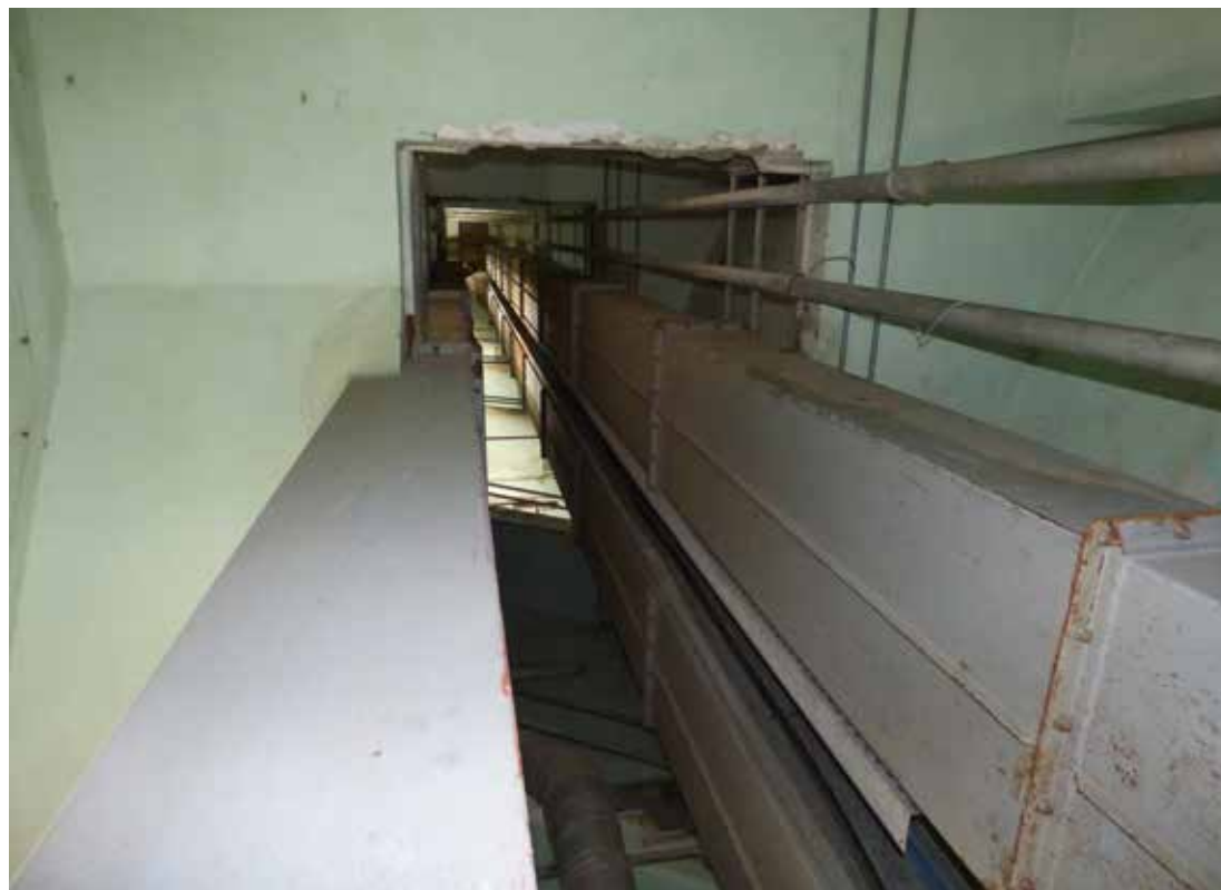
33. Sistema interno di trasferimento verticale con doppi nastri a tazza
